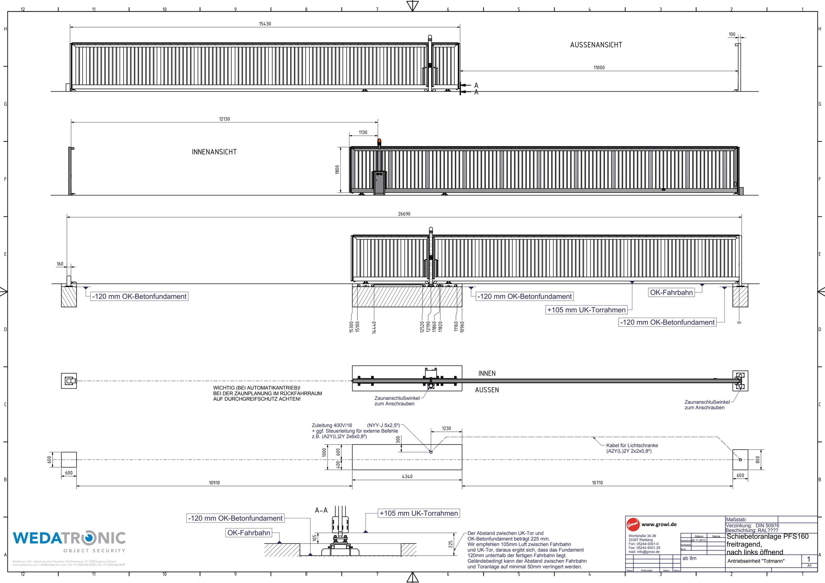
Der Abstand zwischen UK-Tor und OK-Betonfundament beträgt 225 mm. Wir empfehlen 105mm Luft zwischen Fahrbahn und UK-Tor, daraus ergibt sich, dass das Fundament 120mm unterhalb der fertigen Fahrbahn liegt. Geländebedingt kann der Abstand zwischen Fahrbahn und Toranlage auf minimal 50mm verringert werden.
