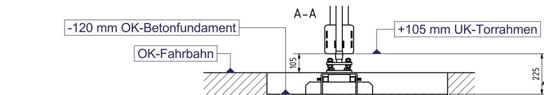
Der Abstand zwischen UK-Tor und OK-Betonfundament beträgt 225 mm. Wir empfehlen 105mm Luft zwischen Fahrbahn und UK-Tor, daraus ergibt sich, dass das Fundament 120mm unterhalb der fertigen Fahrbahn liegt. Geländebedingt kann der Abstand zwischen Fahrbahn und Toranlage auf minimal 50mm verringert werden.
