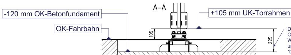
Der Abstand zwischen UK-Tor und OK-Betonfundament beträgt 225 mm. Wir empfehlen 105mm Luft zwischen Fahrbahn und UK-Tor, daraus ergibt sich, dass das Fundament 120mm unterhalb der fertigen Fahrbahn liegt. Geländebedingt kann der Abstand zwischen Fahrbahn und Toranlage auf minimal 50mm verringert werden.
